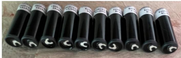
Figure 13 : Photo des 10 émetteurs acoustiques avec capteurs de prédation avec leur membrane digestible (partie blanche) intacte après un mois dans les lamproies marines.
