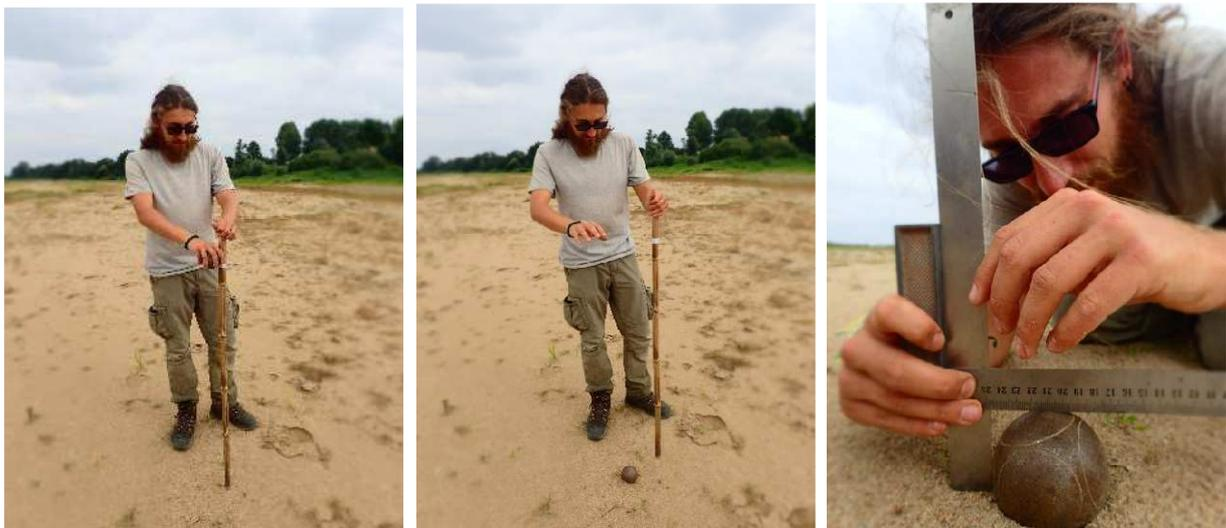
Figure 3 : mode opératoire de la mesure de compacité. La mesure de la partie exogée de la boule après impact se fait à l'aide d'une réglette graduée et d'une équerre, permettant de minimiser les erreurs de parallaxe.
